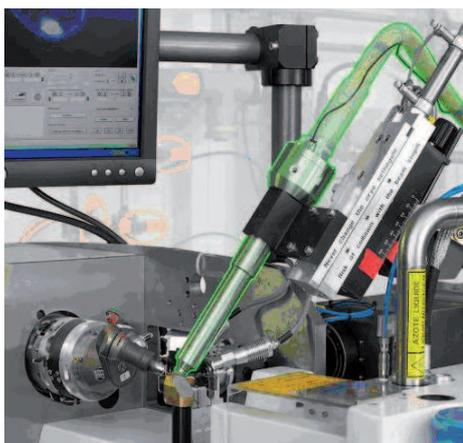
L'expérience est simple : l'appareil peut être installé rapidement sur la ligne, les échantillons sont montés dans des boucles utilisées habituellement en cryogénie et l'impact de la déshydratation peut être contrôlé visuellement au moyen de l'acquisition d'images de diffraction in situ. Une fois le niveau optimal d'hydratation obtenu, la congélation de l'échantillon en vue d'une mesure complète de données est facile à réaliser : soit à la main, soit en utilisant nos changeurs d'échantillons.
